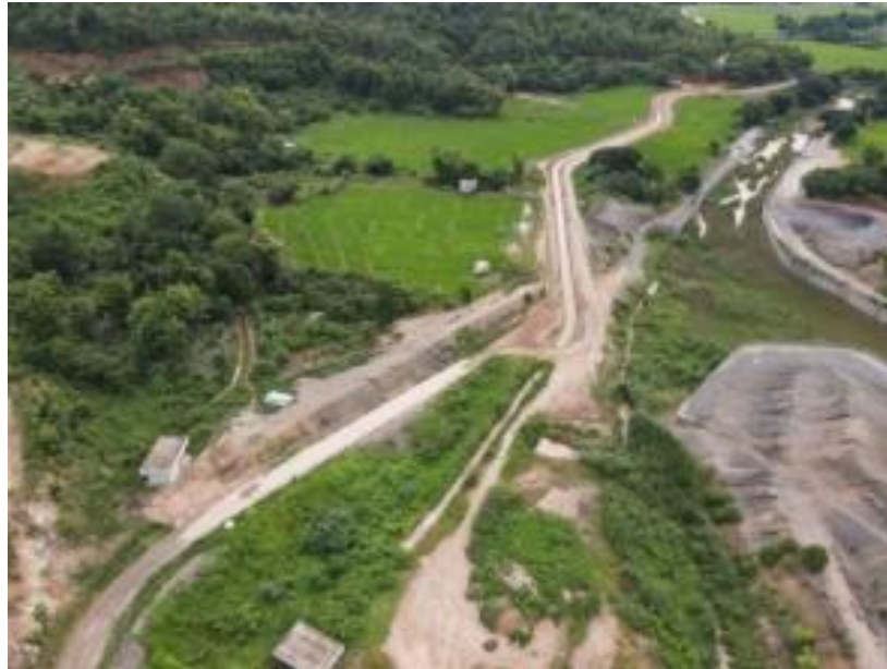
ภาพที่ 1.8 ระบบส่งน้ำพร้อมอาคารประกอบคลองส่งน้ำสายใหญ่ฝั้งซ้าย (LMC) ความยาว 3,529 เมตร
